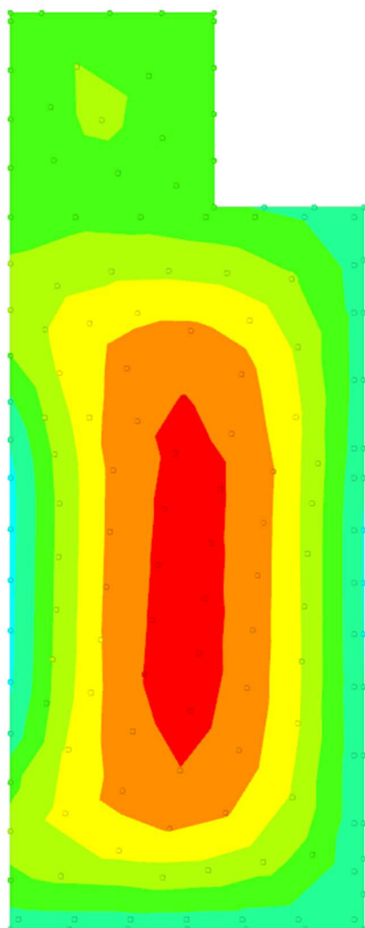
Rappresentazione in pianta delle massime compressioni sul terreno in famiglie SLE/SLD.
